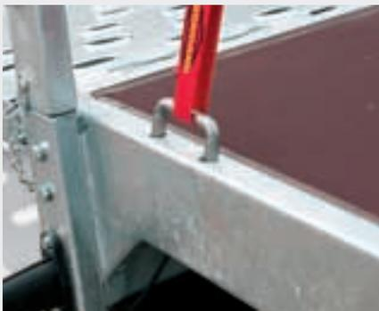
**Mit Sicherheit in aller Ruhe unterwegs:** Mit zusätzlichen klapperfreien Zurrbügeln (Zugkraft bis zu 500 kg) zur Transportsicherung Ihrer Ladung.
